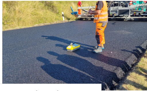
Überprüfung des Verdichtungsgrads mit der Troxler-Sonde (B207) SMA 11 S
